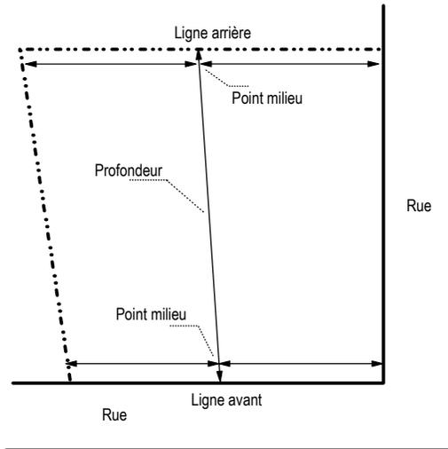
**FIGURE 5.1D : DIMENSIONS D'UN TERRAIN – IRRÉGULIER**
